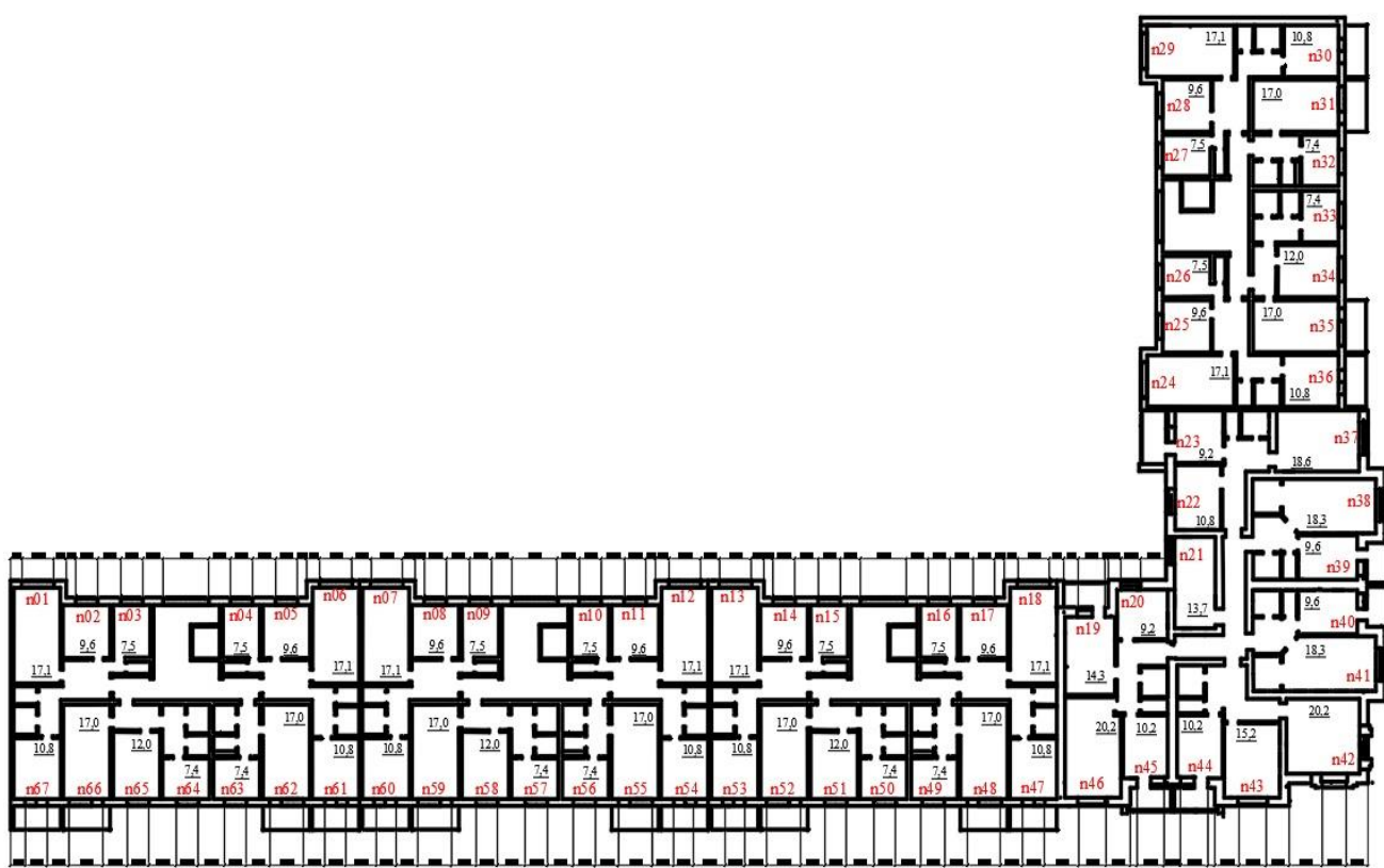
Рисунок 3.4 – План типового этажа многоквартирного дома по ул. Попова: n – номер этажа
