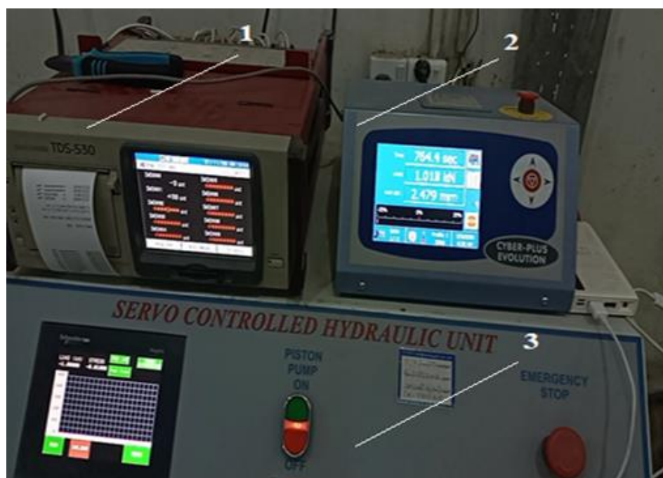
Рисунок 3.20 – Приборы для испытания газобетонных перемычек: 1 – регистратор данных; 2 – прибор LVDT; 3 – гидравлическая машина
