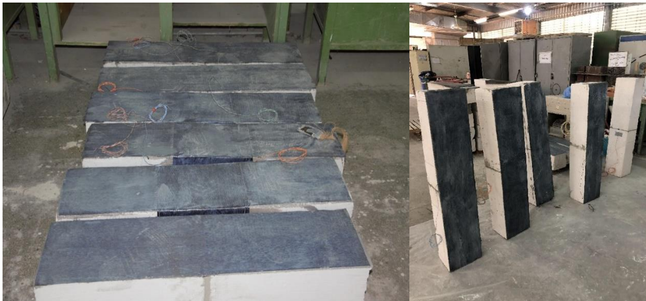
Рисунок 5.4 – Примеры составных перемычек с внешним полосовым и стержневым армированием
